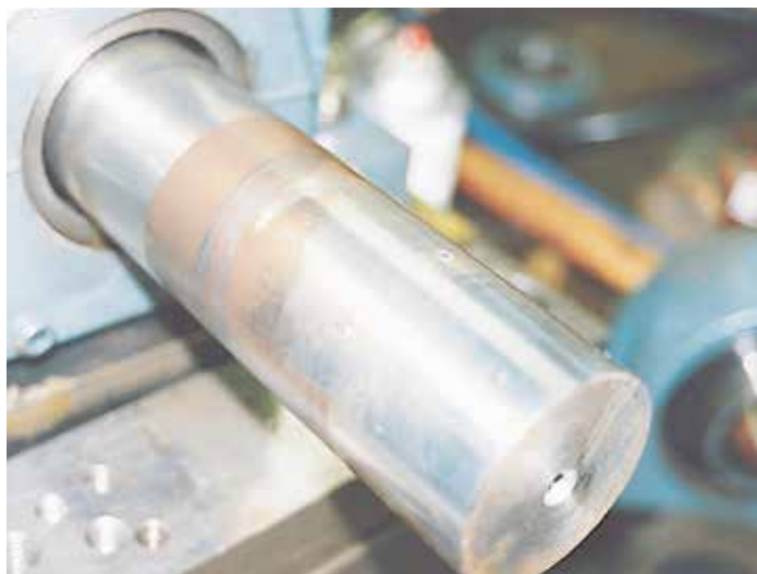
Typowe zużycie cierno-korozyjne i uszkodzenie wału w przypadku oprawy z wkrętami ustalającymi.
