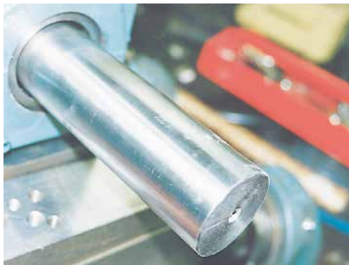
Brak zużycia cierno-korozyjnego czy uszkodzeń wału w przypadku zespołu łożyska z adapterem Grip Tight.
