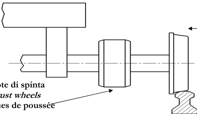
Lavorano solo quando sono afferrate dalla ruota dentata di comando.
